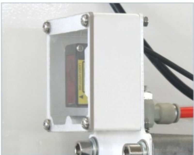
激光测距传感器 Laser aperture
